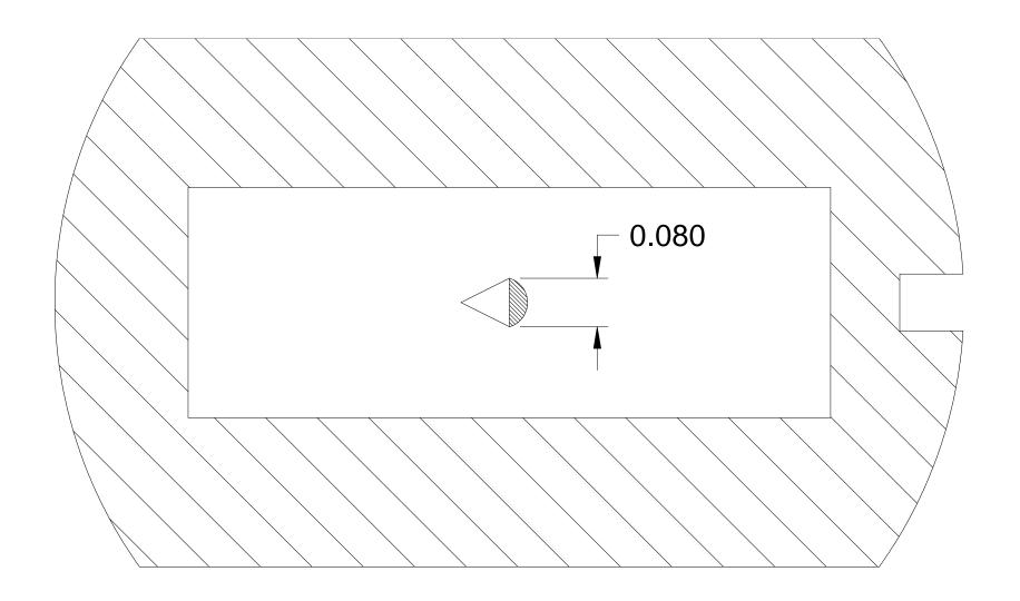
USED FOR LOCATION / ALIGNMENT OF ASSEMBLIES
